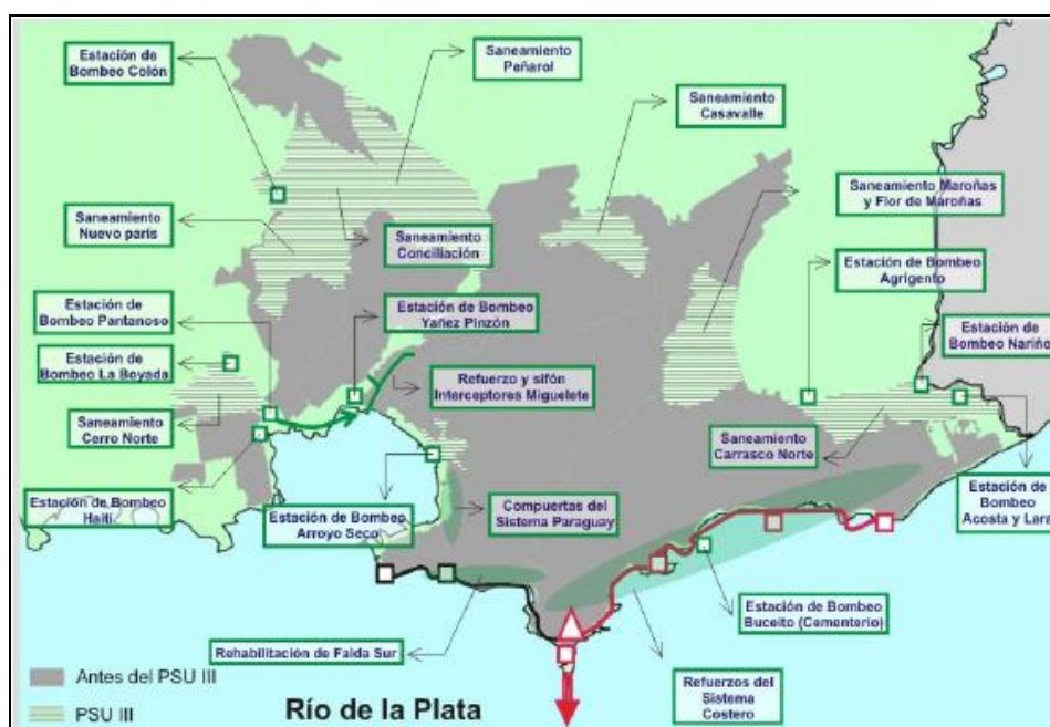
Figura 5. Obras correspondientes al PSU III. (División Saneamiento, IMM)
