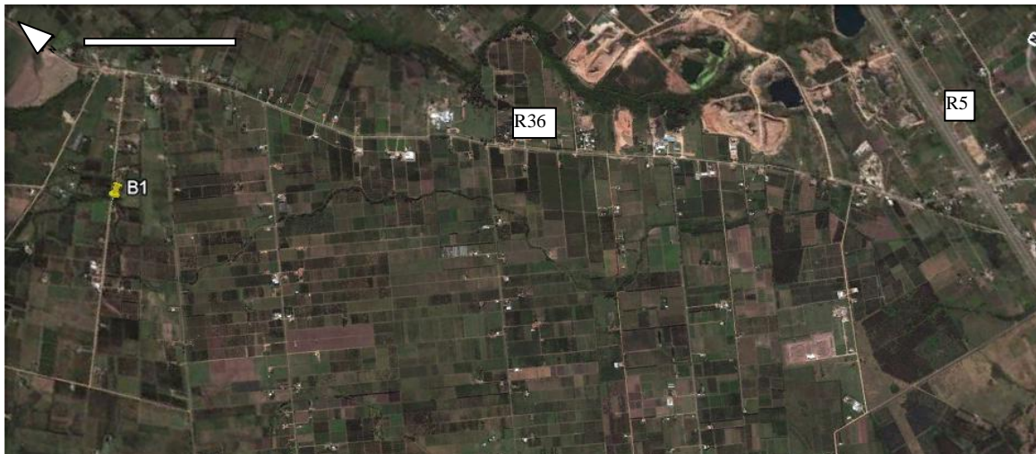
Figura 6: Fotografía satelital de la subcuenca de la estación B1 (enero 2010). El límite este de la cuenca es casi coincidente con la Ruta 36, la naciente del curso principal muy cercana a la Ruta 5. Casi la totalidad del suelo de la subcuenca hasta la estación B1 presenta un uso agrícola intensivo. La barra superior izquierda representa 1 km.
