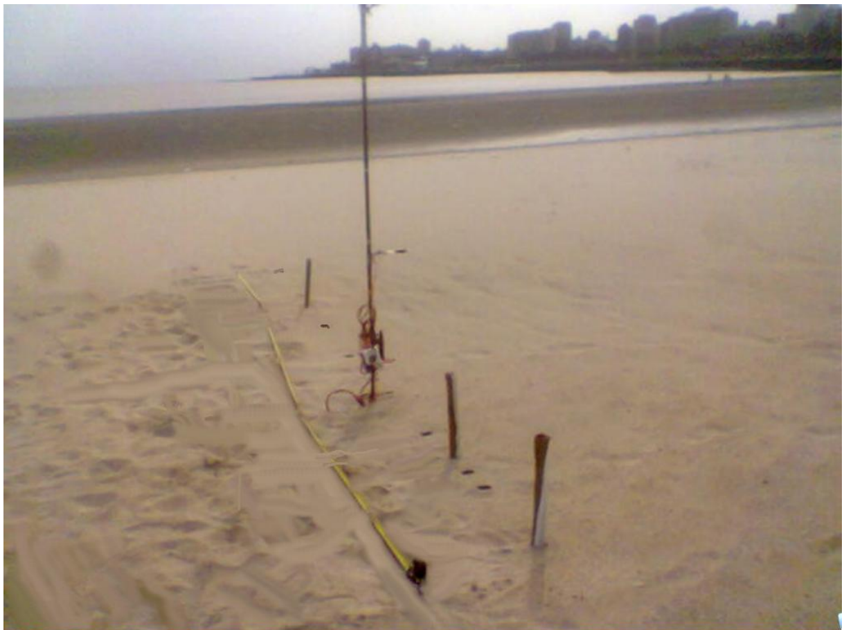
Figura 3. Fotografía de la zona de playa muestreada, con tres trampas verticales, 6 trampas horizontales y tubos pitot a 2, 20, 100 y 200cm de la superficie. La cinta indica 5 metros. Fecha: 10 de octubre 16hs. Viento moderado del NNE (derecha a izquierda de la imagen).
