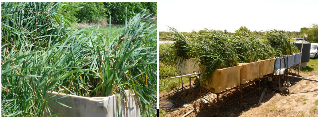
Figura 17. Se ilustra el disturbio, caída de macrófitas, que en el modelo experimental se produjo como consecuencia de fuertes vientos y lluvias entre los días 23 y 30 de octubre del año 2012.
