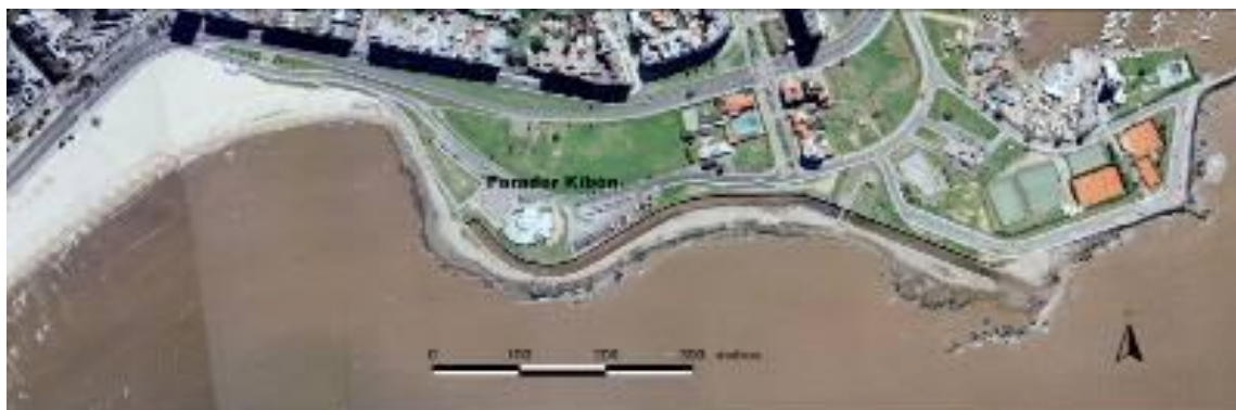
Figura 7. En la imagen de 2007 puede observarse el entubado y canalización de la desembocadura del Arroyo Grande de los Pocitos, que pasa a desaguar a 1.000 metros del lugar original, parte del tramo conducido bajo subsuelo. Foto: 2007, IMM.
