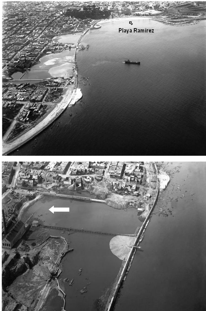
Figura 14. La Rambla Sur, consistió en 4.000 metros de rambla desde la calle Jackson hasta la escollera Sarandí, su construcción se realizó sin respetar la forma de la costa ni las dos playas existentes (Santa Ana y Patricios, una de las cuales formaba parte de la original configuración original de Ramírez ), e insumió unos 500.000 m 3 de arena y piedra. Obsérvese como en la foto de abajo, la flecha blanca señala una de las playas que quedaría luego tapada por el relleno. Fotos: CMDF-IMM.
