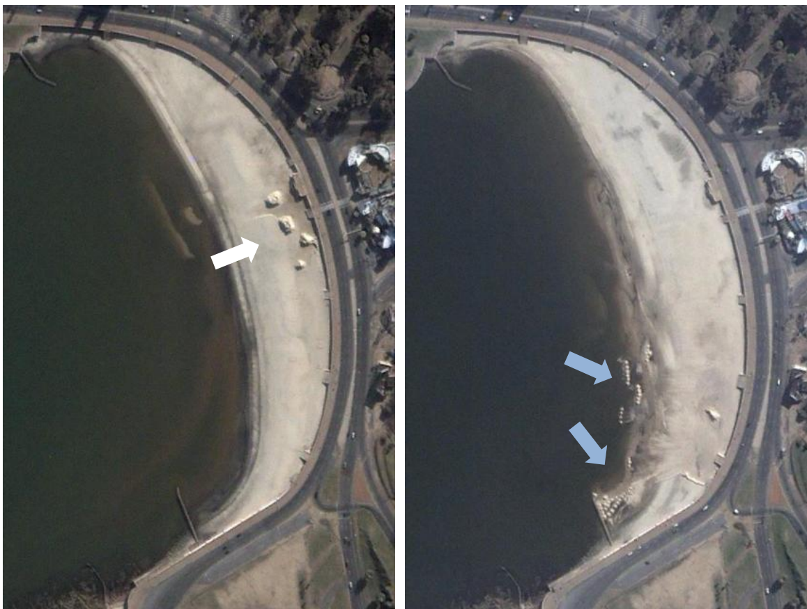
Figura 22. Izquierda: La flecha blanca señala las acumulaciones artificiales de arena realizadas en las tareas de limpieza (28 de junio de 2001). Derecha: Las flechas celestes indican los lugares en que la arena es depositada en la zona de "surf" (8 de agosto de 2001). Imágenes: Digital Globe, Google Earth 5 .
