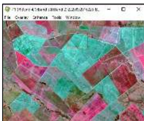
Figura 1. Imagen en falso color compuesto de una porción del área de estudio (RGB:543). El cuadrante rojo se posiciona sobre un potrero con suelo desnudo (superficie de color celeste). Las porciones de territorio con distinto grado de cobertura vegetal, varían en las distintas tonalidades de rosa.
